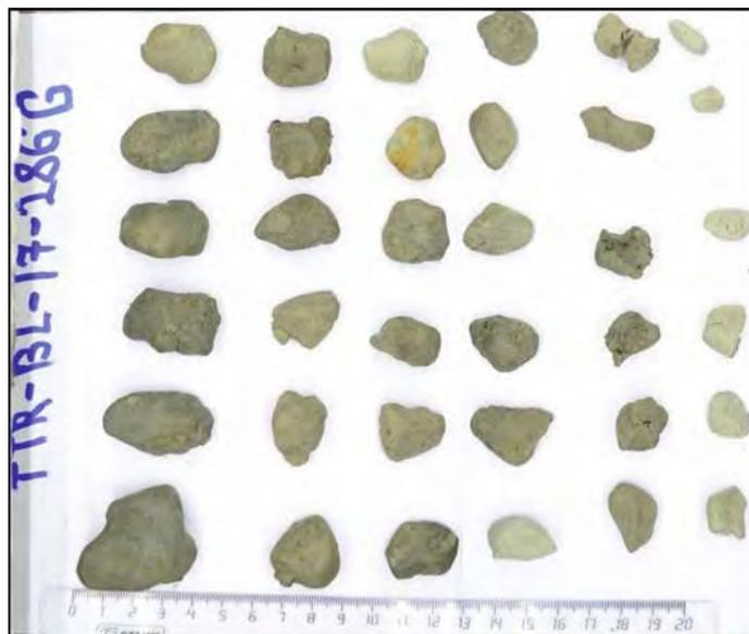
Рисунок 11. Обломки пород из грязевулканических отложений. Станция TTR-BL17-286G
