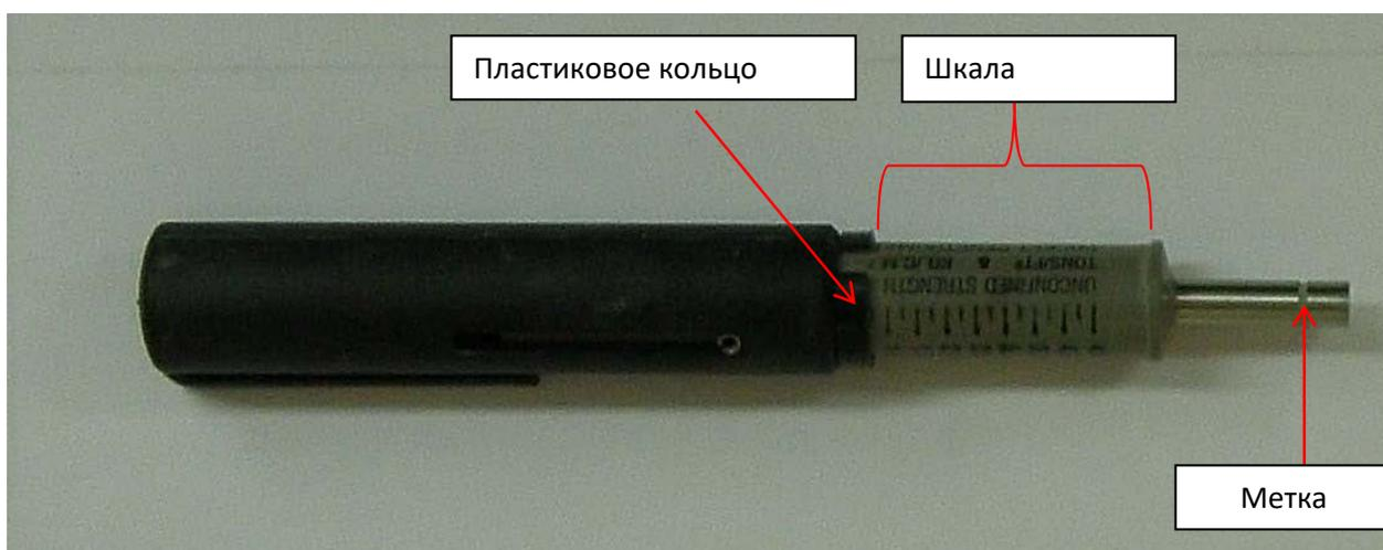
Рисунок 2. Пенетрометр
