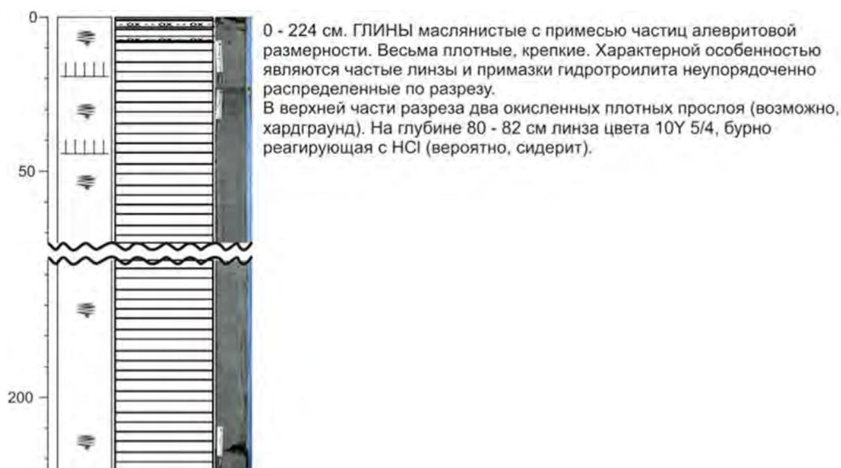
Рисунок 4. Пример строения разреза станции TTR-BL17-257G
