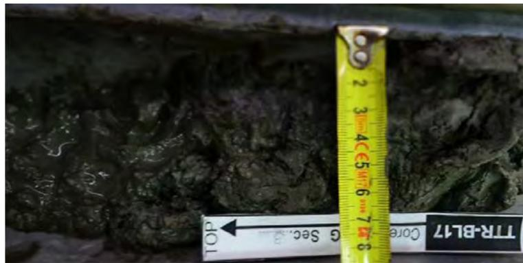
Рисунок 10. Плотные фрагменты глины в нижней части разреза станции TTR-BL17-284G
