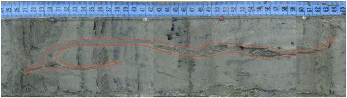
Рисунок 4. Канал миграции флюида на примере керна станции TTR-BL17-283G
